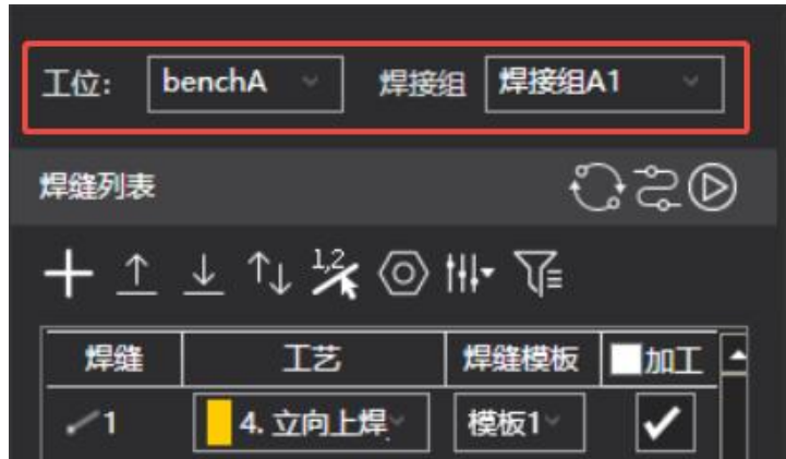
图 7-18 工位及焊接组切换
