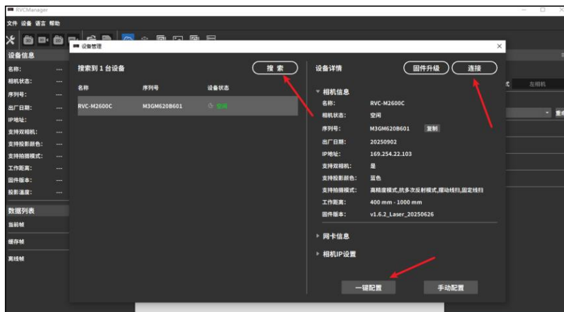
图 5-2 搜索相机并配置 IP
