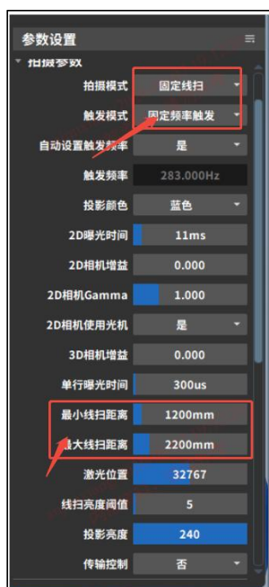
图 5-4 设置采集模式和线扫距离
