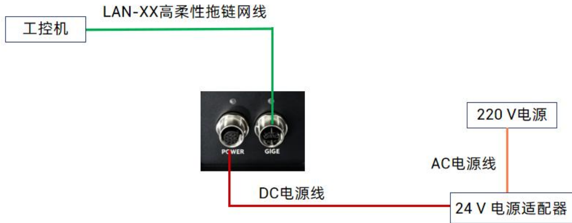
图 2-3 BCW4101P 接线示意图
