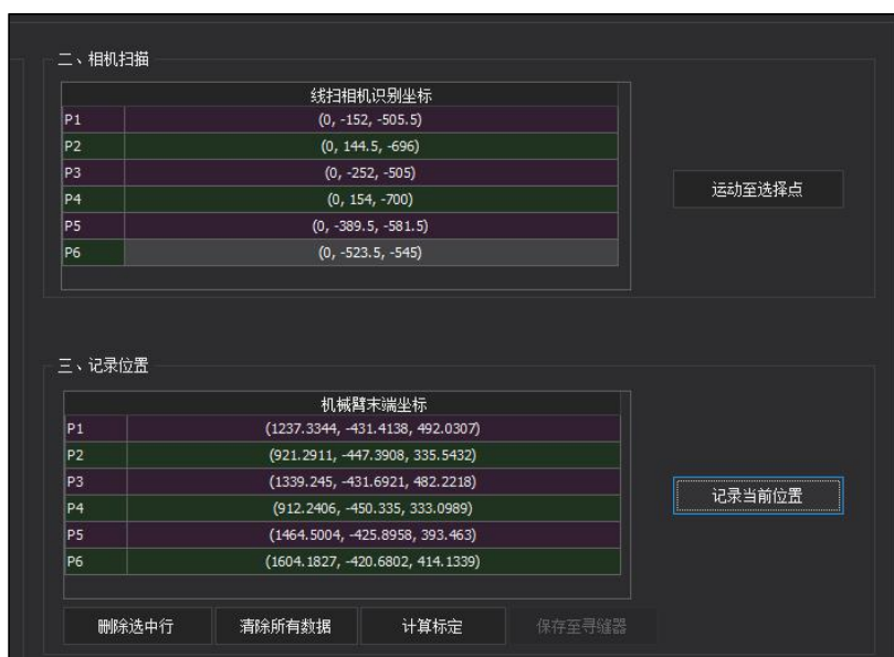
图 5-37 完成机械臂末端坐标采集
