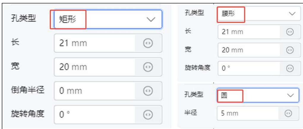
图 4-18 不同标准孔的配置参数展示
