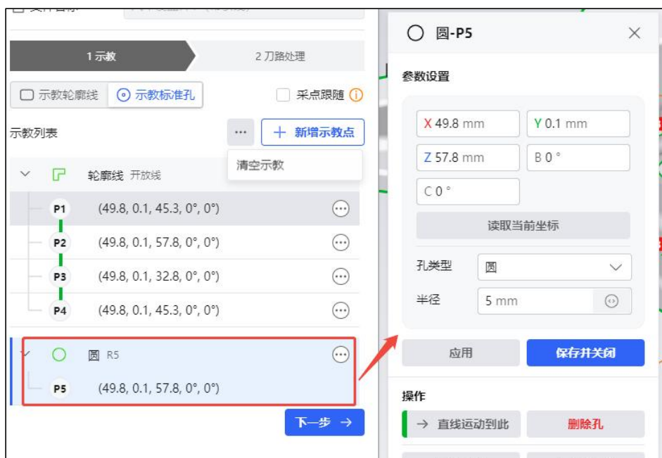
图 4-17 标准孔示教配置
