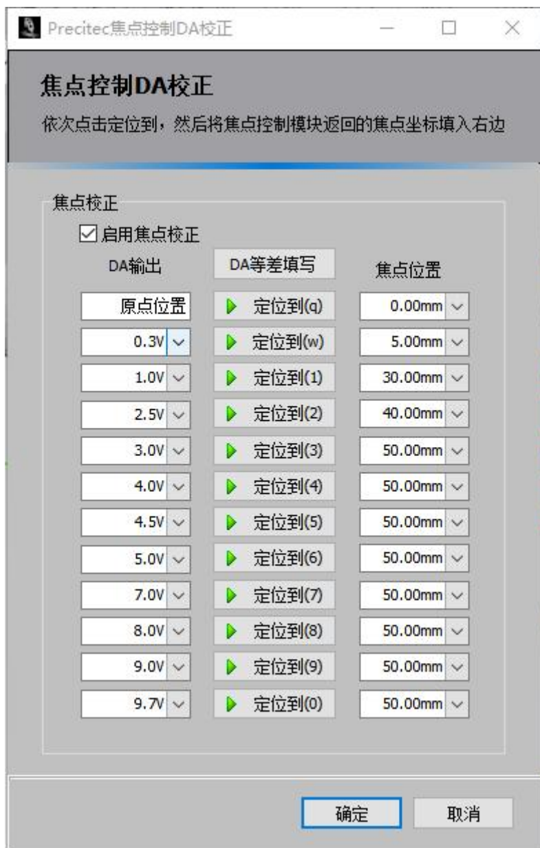
图 3-20 焦点 DA 校正
