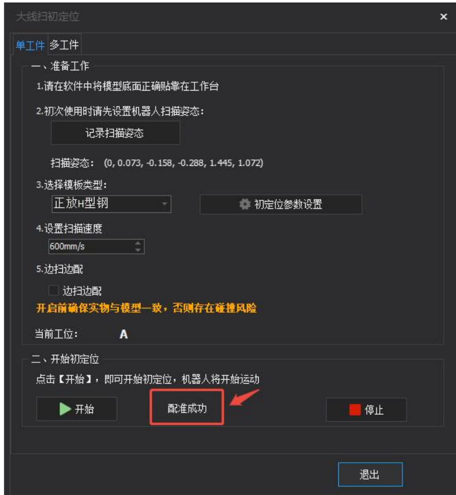
图 4-7 大线扫初定位成功
