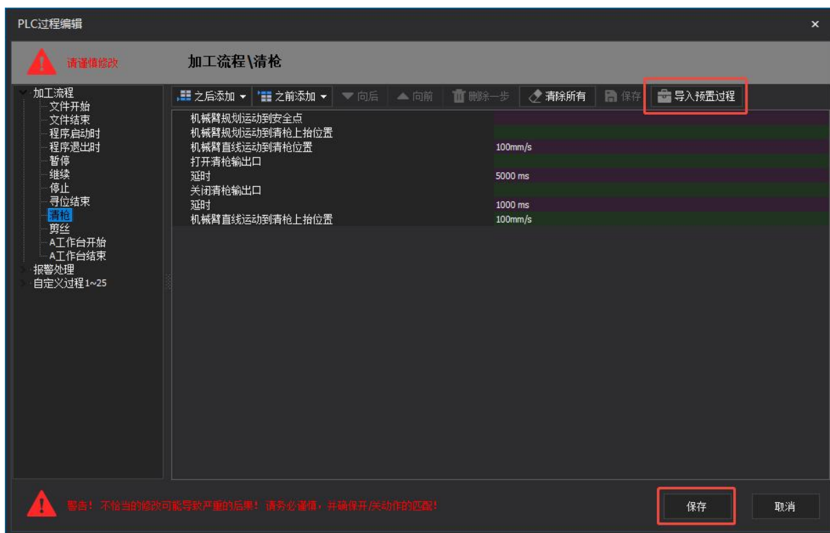
图 9-4 清枪 PLC 流程
