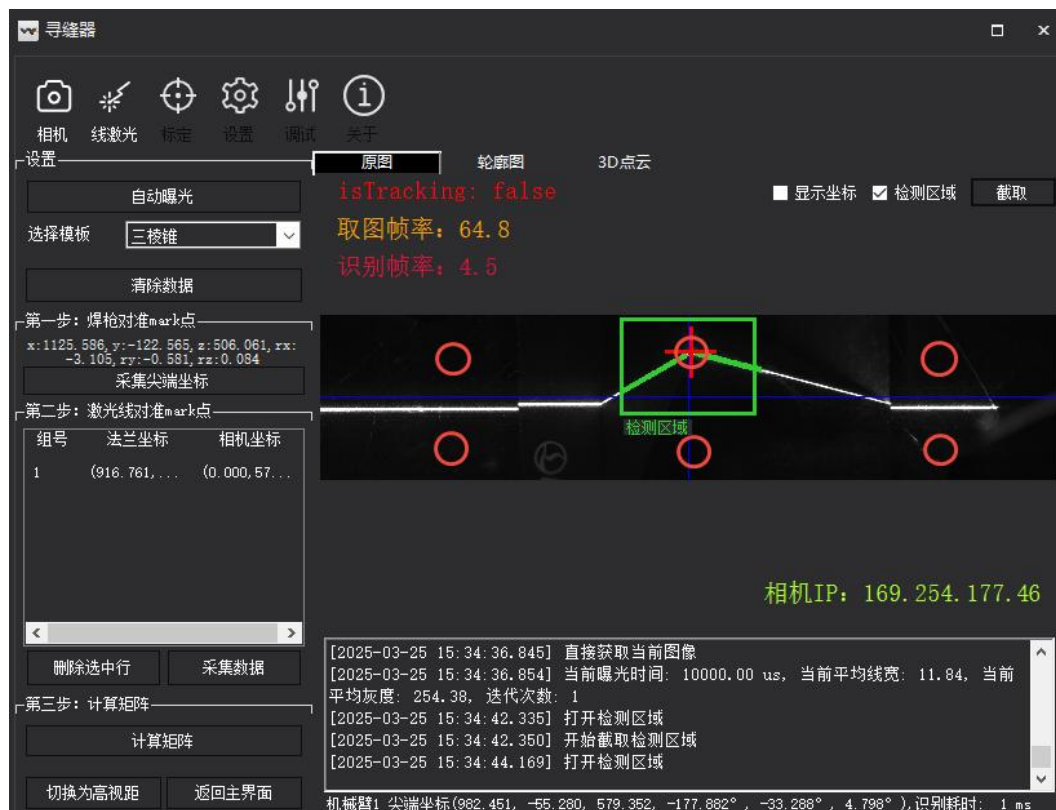
图 3-7 激光线对准 mark 点（以三棱锥为例）
