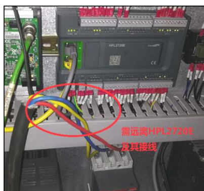
图 4-8 错误示范（干扰较大负载未与焊接系统产品分离）
