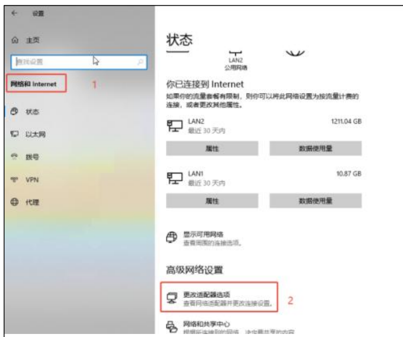
图 6-3 检查网口 IP 分配配置
