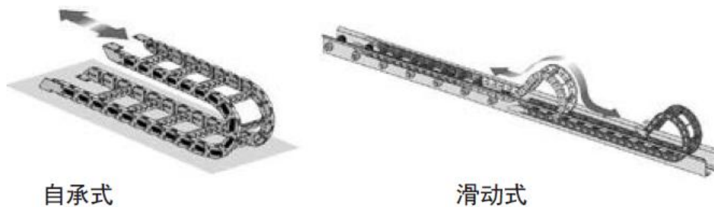
图 5-13 自承式/滑动式拖链结构
