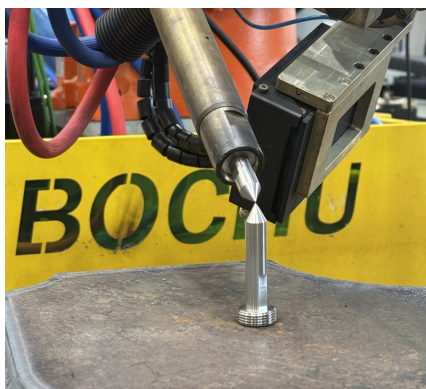
图 4-7 短标定针对准标定件尖端
