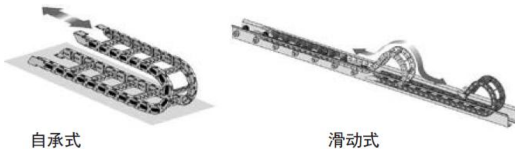
图 5-13 自承式/滑动式拖链结构
