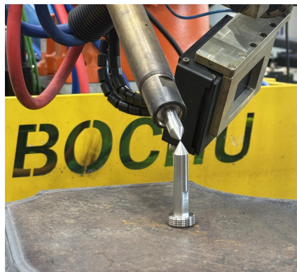
图 3-7 短标定针对准标定件尖端
