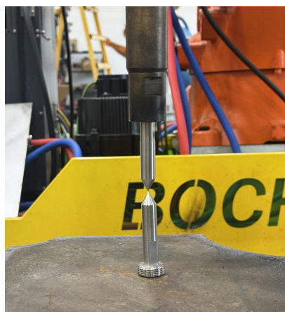
图 3-2 割枪垂直并且末端对准标定件尖端
