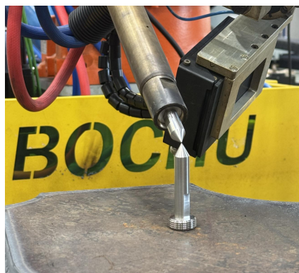
图 3-7 短标定针对准标定件尖端
