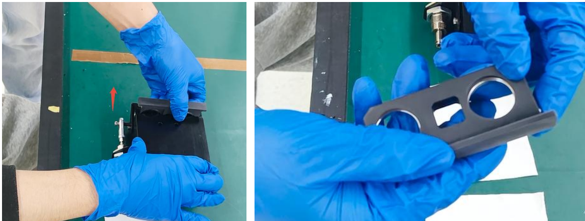
图 3-5 向上拉出取出保护镜抽屉
