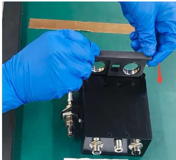
图 3-8 将抽屉装回 BCW400H
