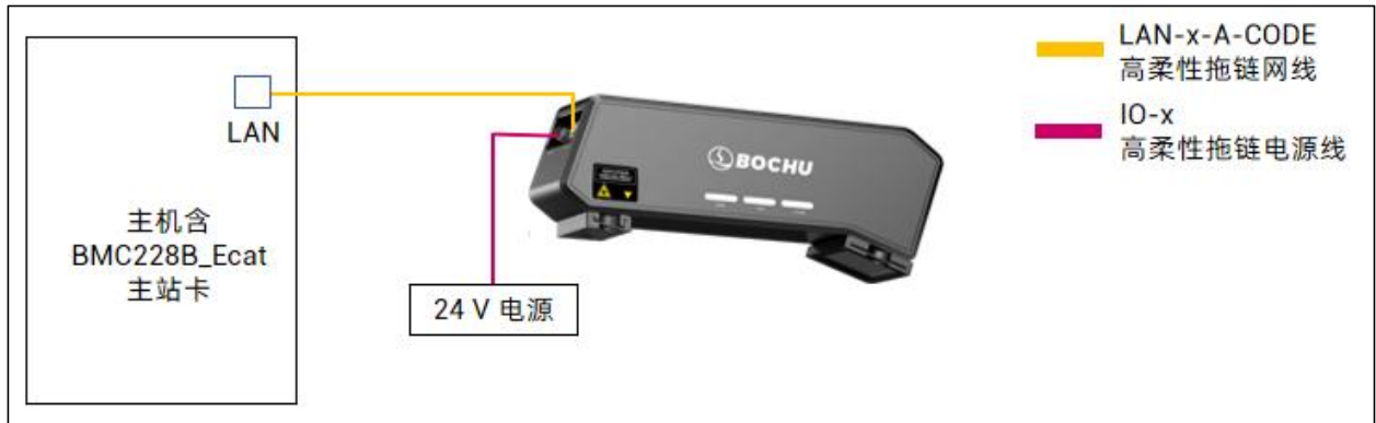
图 2-3 BCW101H 线激光立体相机接线示意图
