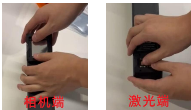
图 3-9 保护镜片更换
