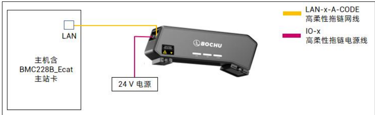
图 2-3 BCW101H 线激光立体相机接线示意图
