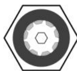
图 2-3 J02 冷却气输入接口
