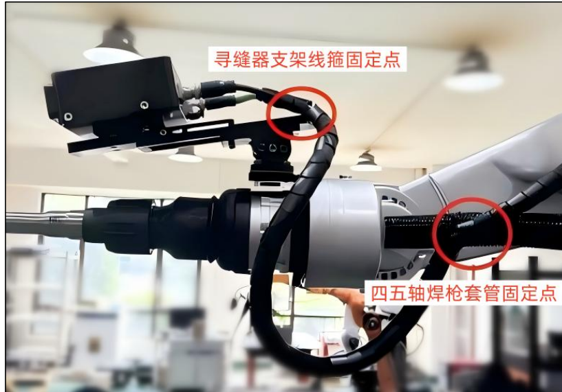
图 4-16 寻缝器支架线箍固定点和四五轴焊枪套管固定点
