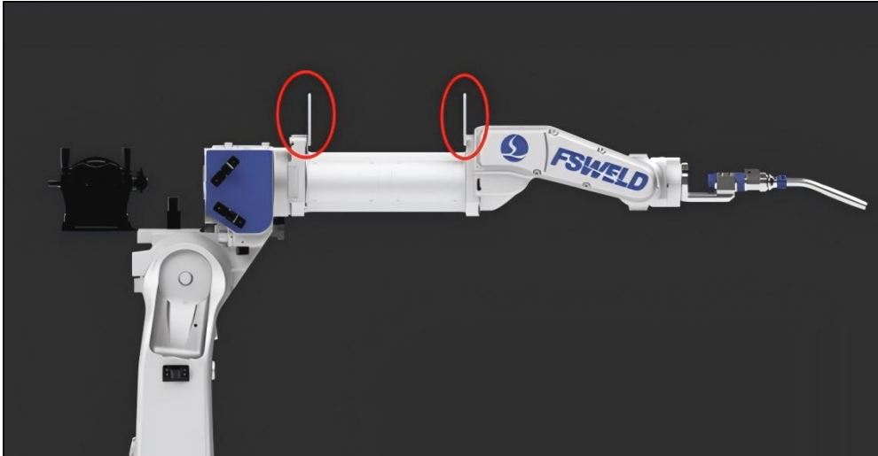
图 4-17 四五轴连杆托线板 2 点
