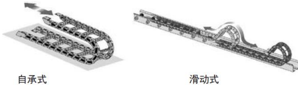
图 4-13 自承式/滑动式拖链结构
