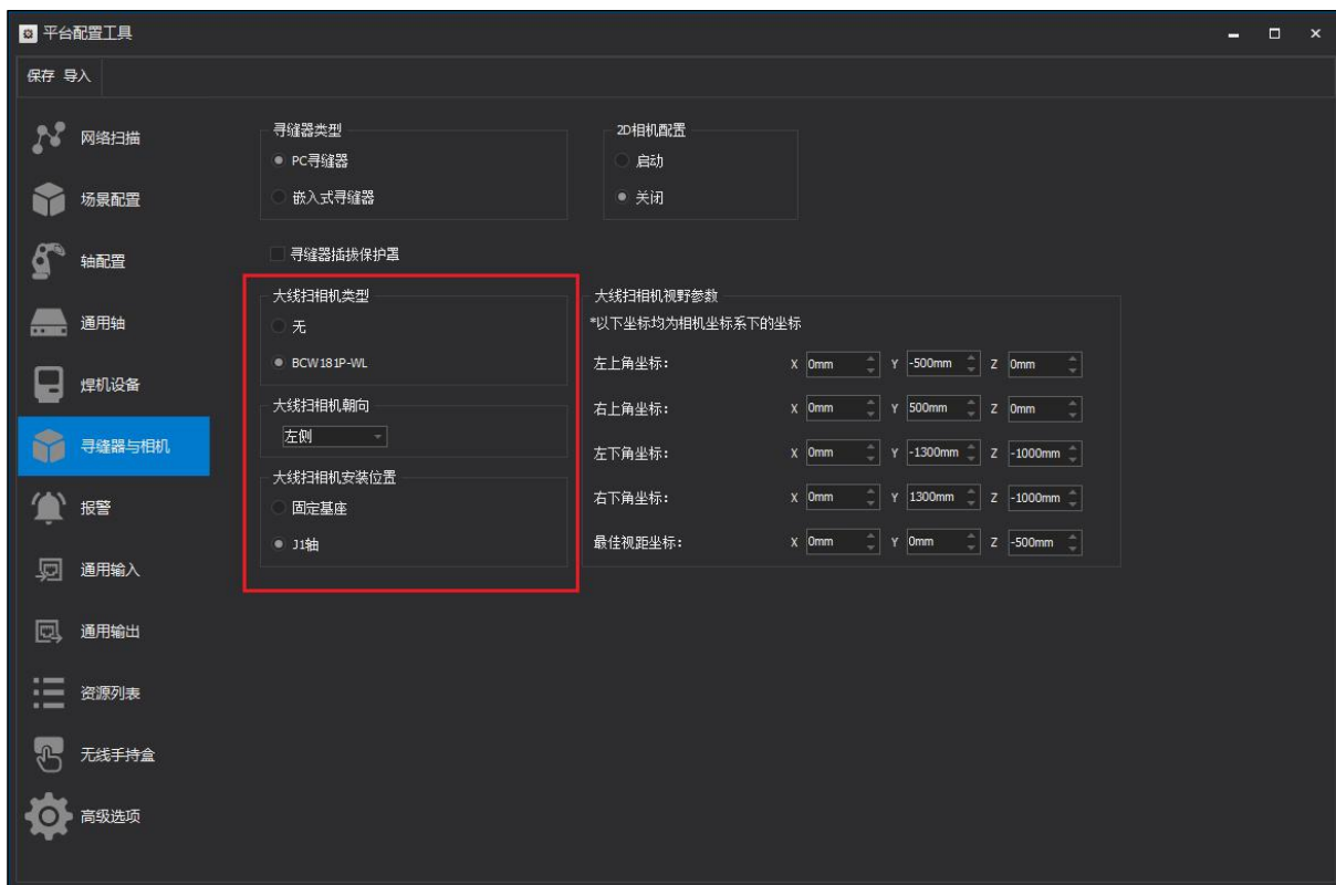
图 3-1 设置大线扫相机类型和安装位置
