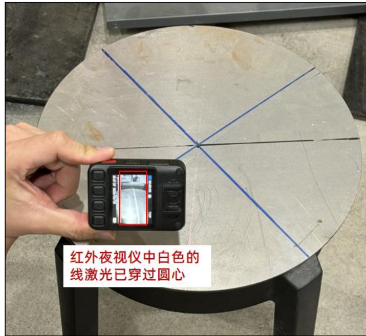
图 3-20 使用红外夜视仪观察线激光位置
