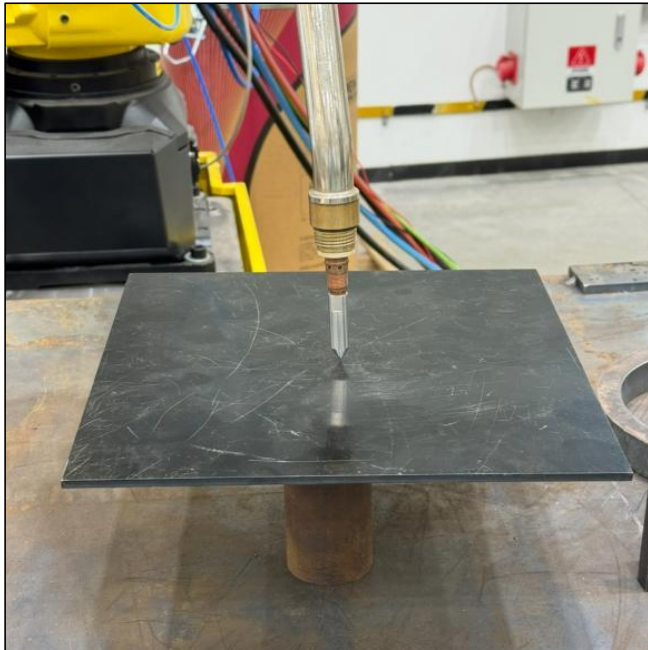
图 3-30 TCP 对准标定盘中心
