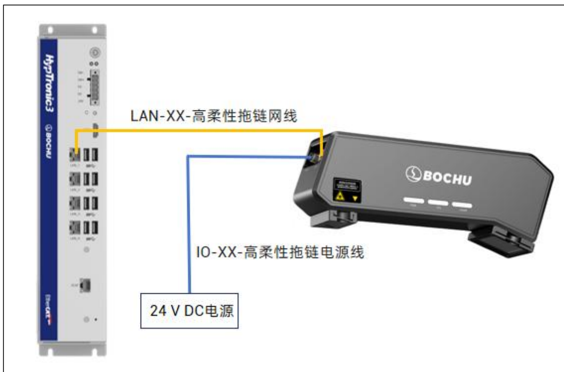
图 2-3 BCW181P 线激光立体相机接线示意图
