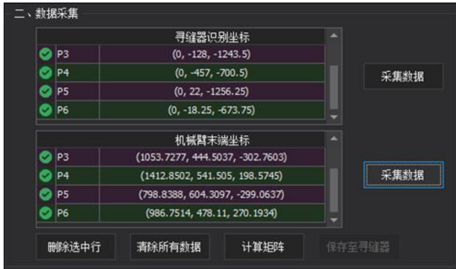
图 3-24 重复操作完成 6 组数据采集
