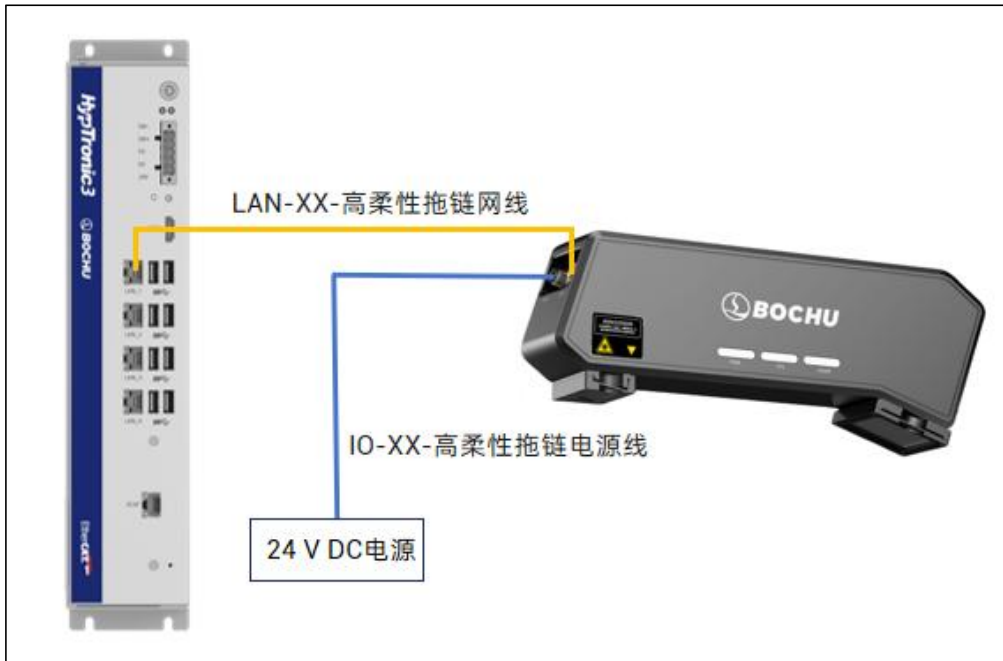
图 2-3 BCW181P 线激光立体相机接线示意图
