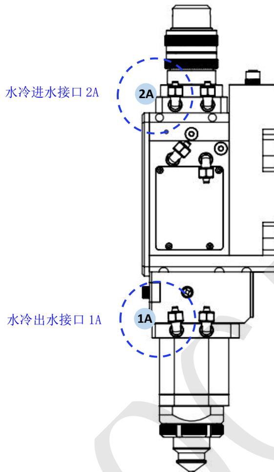
安装连接：水冷进水接口 2A, 水冷出水接口 1A
