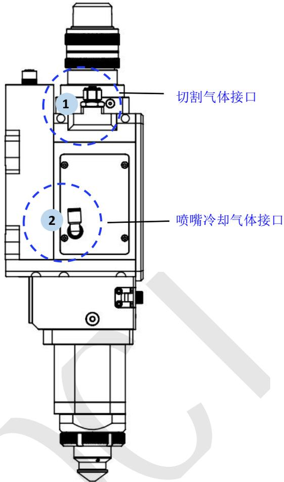
安装连接：切割气体 1、喷嘴冷却气体 2
