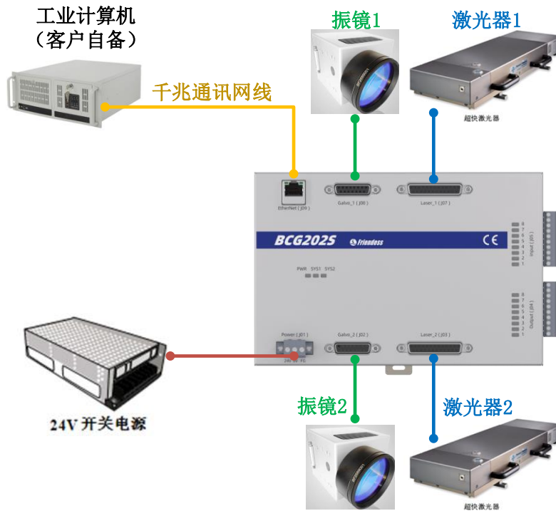
图 3 BCG202S 振镜控制器接线方案
