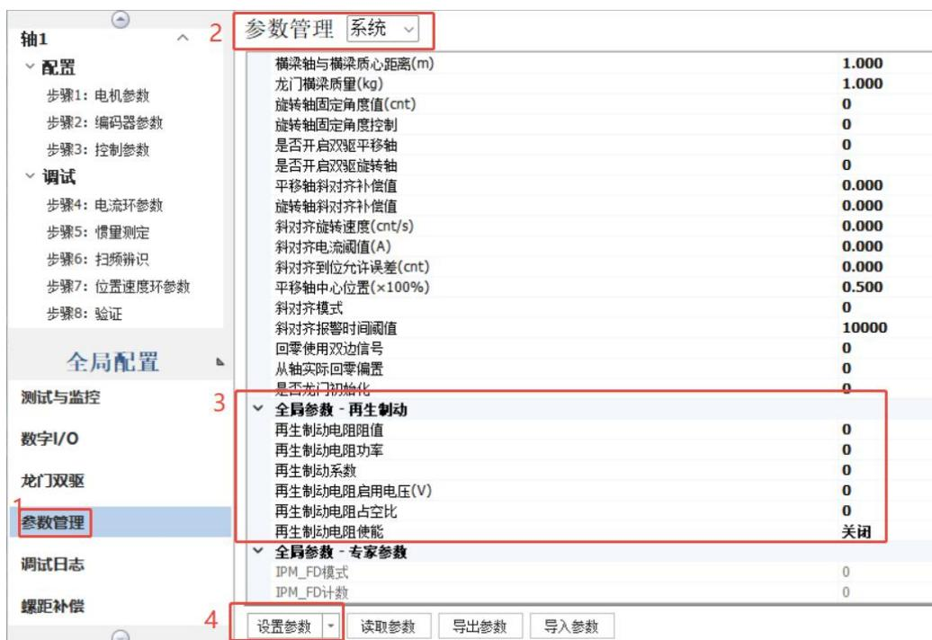
图 9-22 再生电阻参数设置步骤
