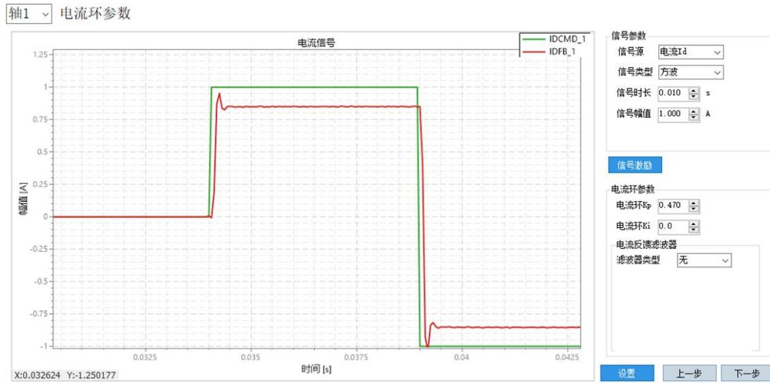
图 10-11 电流指令和电流反馈的对比曲线 (b)
