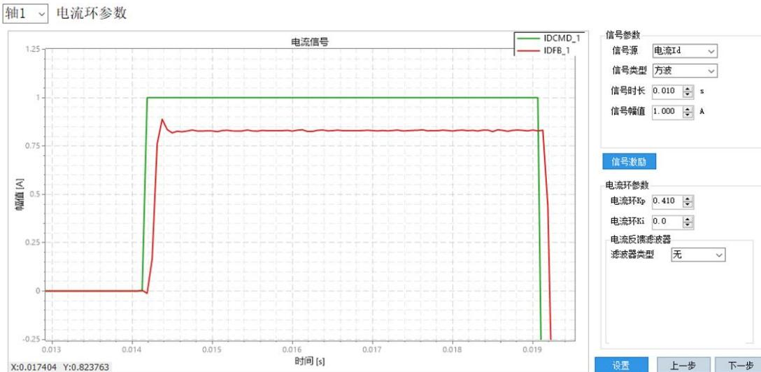
图 10-10 电流指令和电流反馈的对比曲线 (a)
