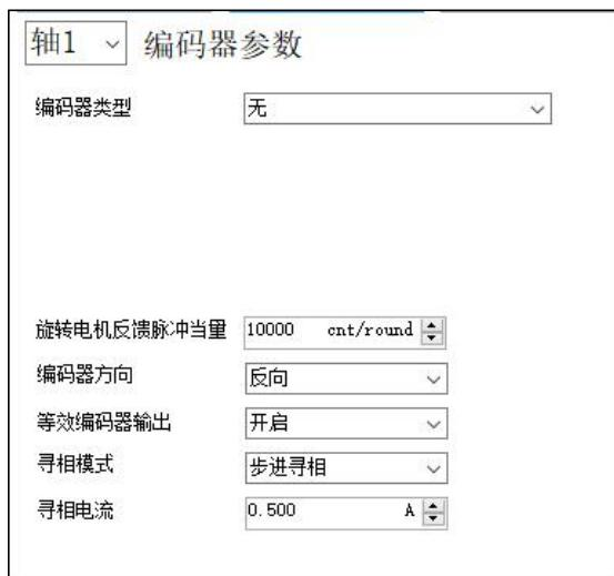
图 10-4 设置寻相相关参数
