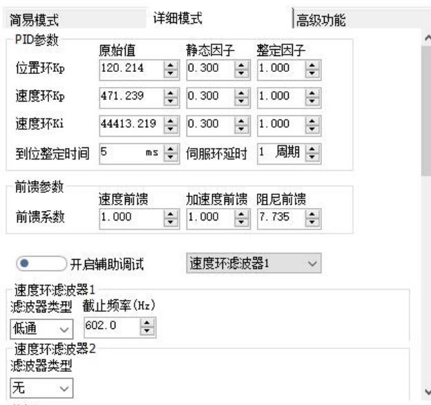
图 10-30 手动整定的核心参数
