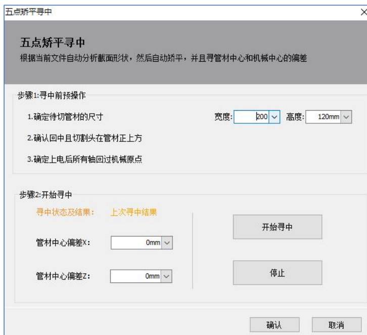
图 4-45 五点矫平寻中
