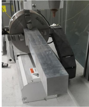
图 2-6 标定 B 轴中心示意图
