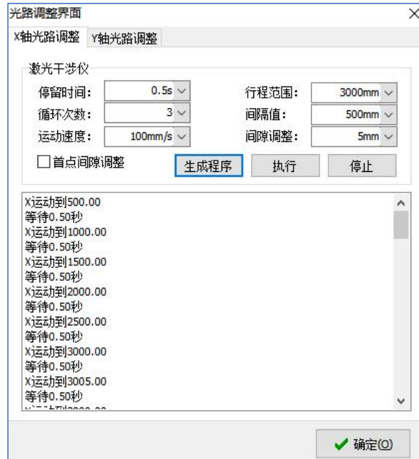
图 4-68 激光干涉仪程序
