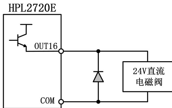
图 5-3 电磁阀两端并联续流二极管示意图
