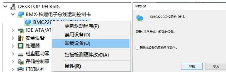
图 6-1 卸载控制卡
