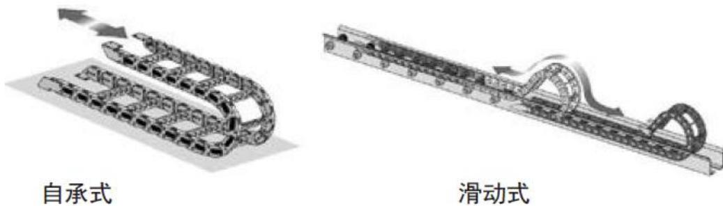
图 5-2 自承式拖链与滑动式拖链
