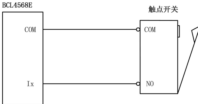
图 2-15 触点开关接线示意图
