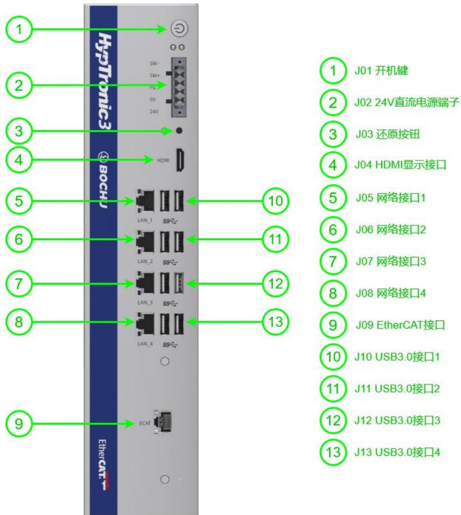
图 2-1 HypTronic3 接线端子接口布局图
