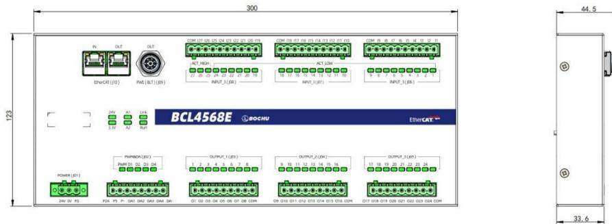
图 2-7 BCL4568E 尺寸图 (单位: mm)
