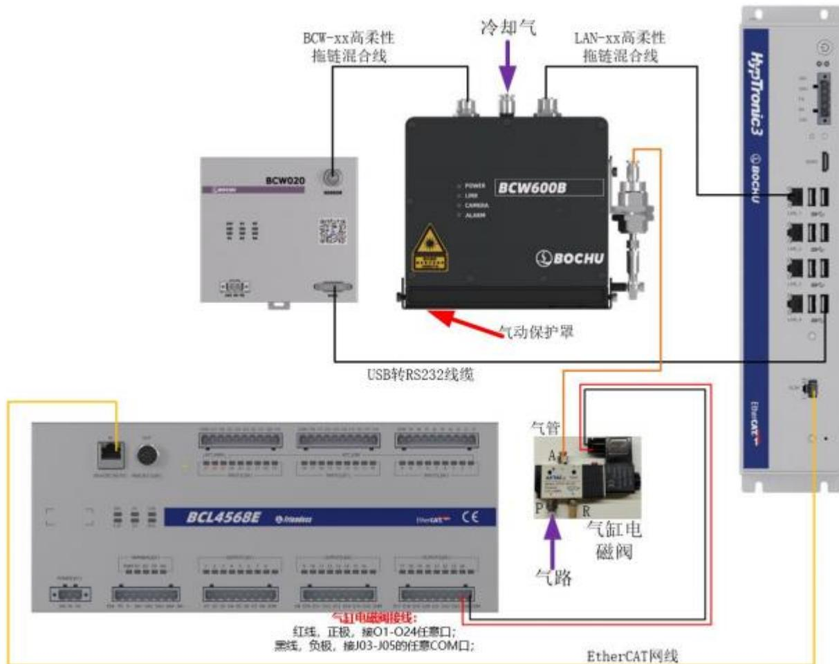
图 2-24 系统接线方案框图
