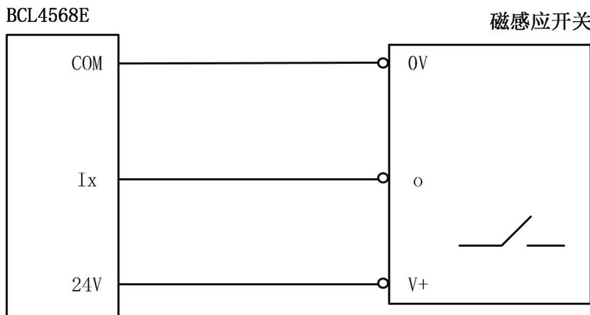
图 2-16 磁感应开关接线示意图
