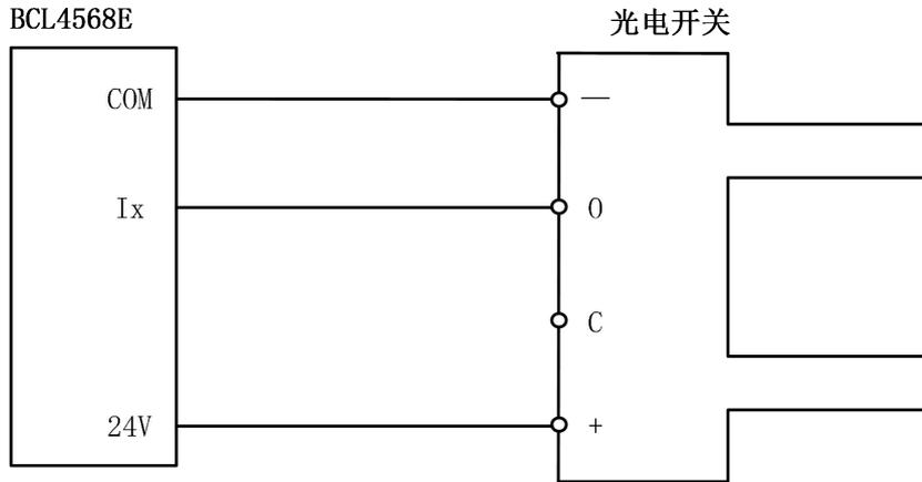
图 2-14 光电开关接线示意图
