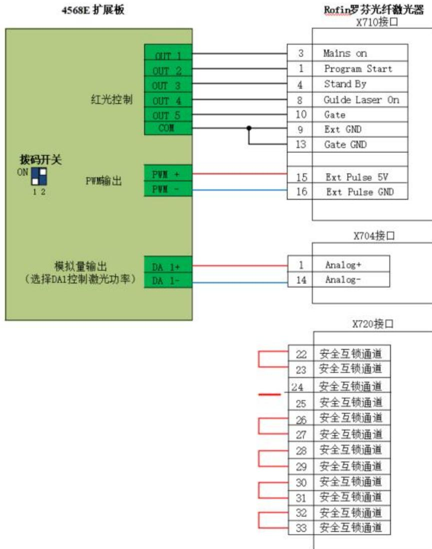
图 2-34 罗芬激光器接线示意图
