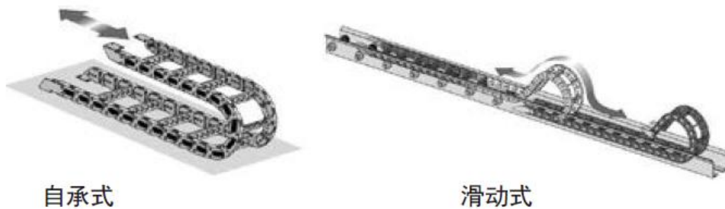
图 5-2 自承式拖链与滑动式拖链
