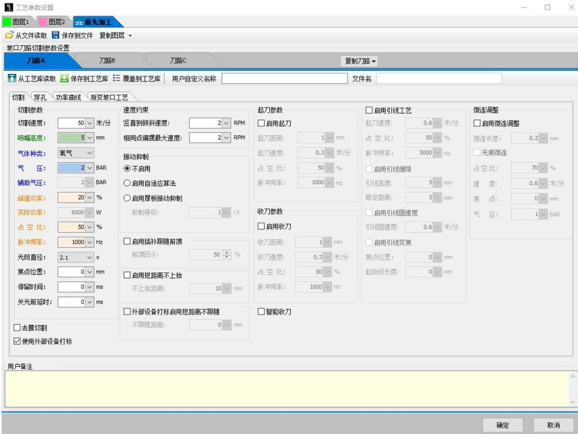
图 10-18 打标图层工艺参数设置
