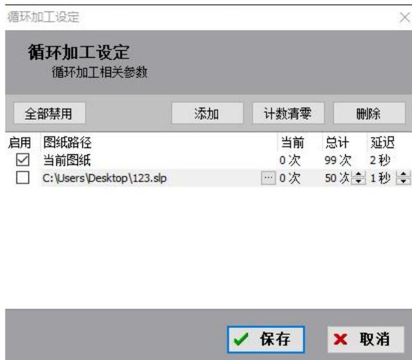
图 10-22 循环加工设定
