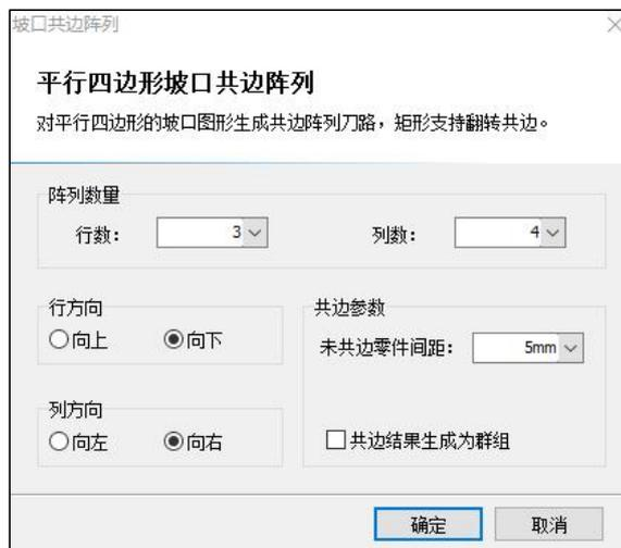
FACut 对 V 坡支持翻转共边；对上下对称的 X 坡/K 坡支持完全共边；对阵列中无法翻转共边或完全共边的行/列，会按设置的未共边零件间距进行伪共边。下两图依次为坡口翻转共边/完全共边阵列示意图和坡口部分采用伪共边的阵列示意图。
