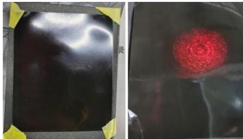
**第4步** 换上直径大于  $3.0 \text{ mm}$  的单层喷嘴，焦点选 0 焦；选择相纸功能，输入参数（参数设置：实际功率 10000 W 左右，不足万瓦的输入最高功率；占空比 100%；频率 5000 Hz；出光时间 25 ms），点激光。
