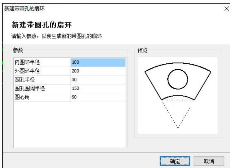
图 2-19 标准零件参数设置
