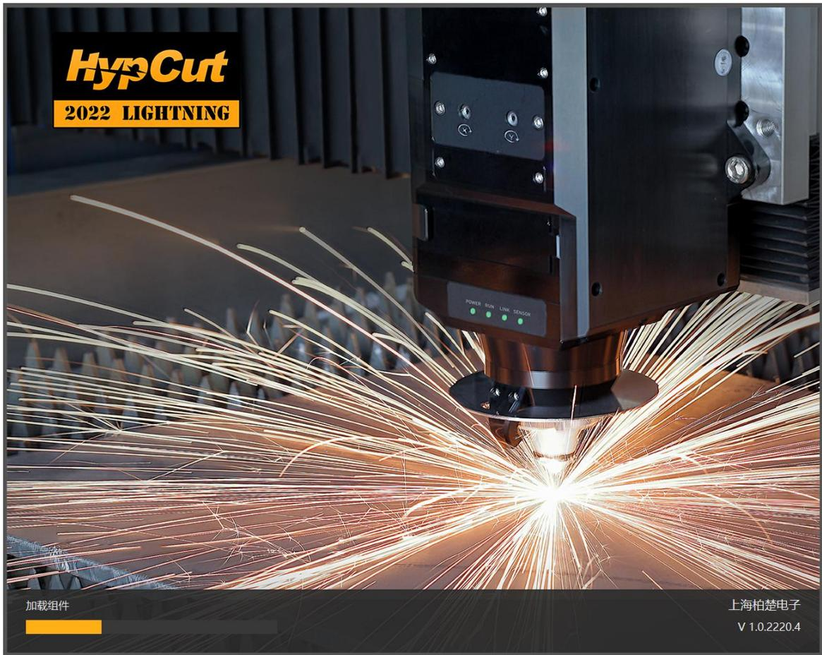
请在运行 HypCut 之前检查所有电气元器件是否正确连接或启动成功。系统启动时执行模块加载与自检流程，自检通过后系统会自动弹出回原点对话框。
