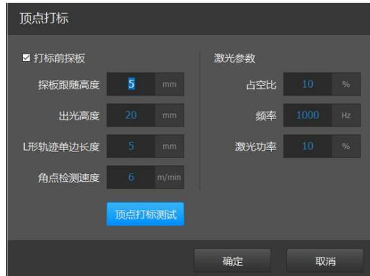
【顶点打标】作用与【走边框】类似，都可用于确定加工图形是否在板材内部，该功能只能在停止时使用。尤其在加工大板材时，可避免走边框时需要人盯着红光以判断图形是否在板材上，只需观察打标时是否在板材上出光即可。
