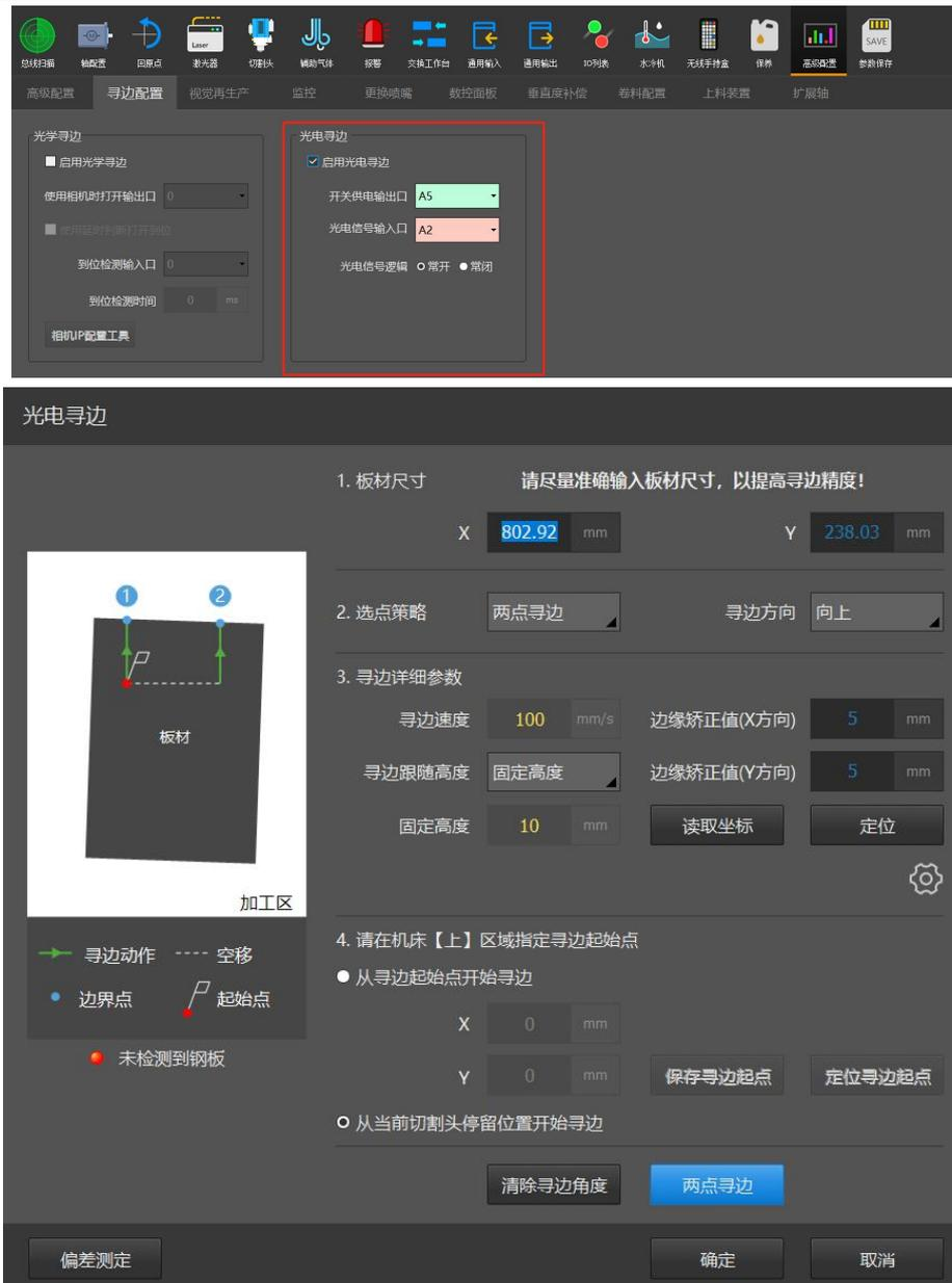
点击页面中的【偏差测定】，可以测量光电开关与切割头喷嘴中心的偏差值。测定步骤如下：
