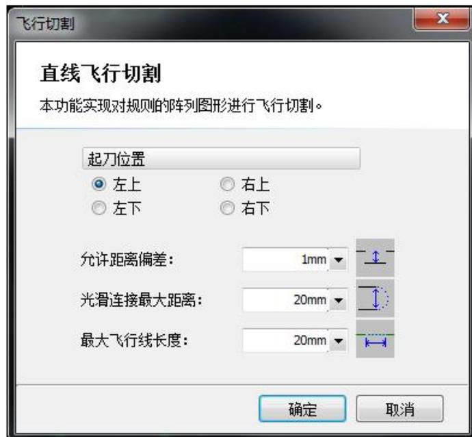
当规则阵列的组成图形全部是圆时，直接单击“飞切按钮”，即为圆弧飞行切割功能，或单击“飞切”按钮下拉菜单中的“圆弧飞行切割”选项，进入圆弧飞行切割参数设置界面。
