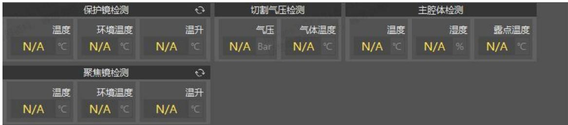
1. 保护镜监测：显示保护镜温度、保护镜环境和温升信息。
