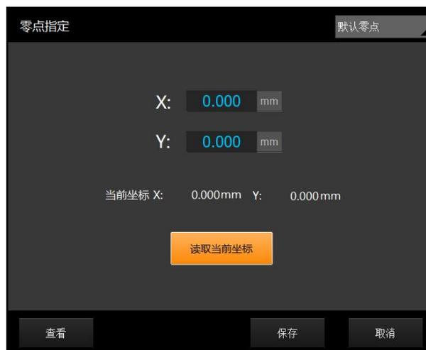
零点指定可以手动输入指定坐标值或将机床移动到指定位置再复制当前坐标，确定加工的工件坐标系参考点。
