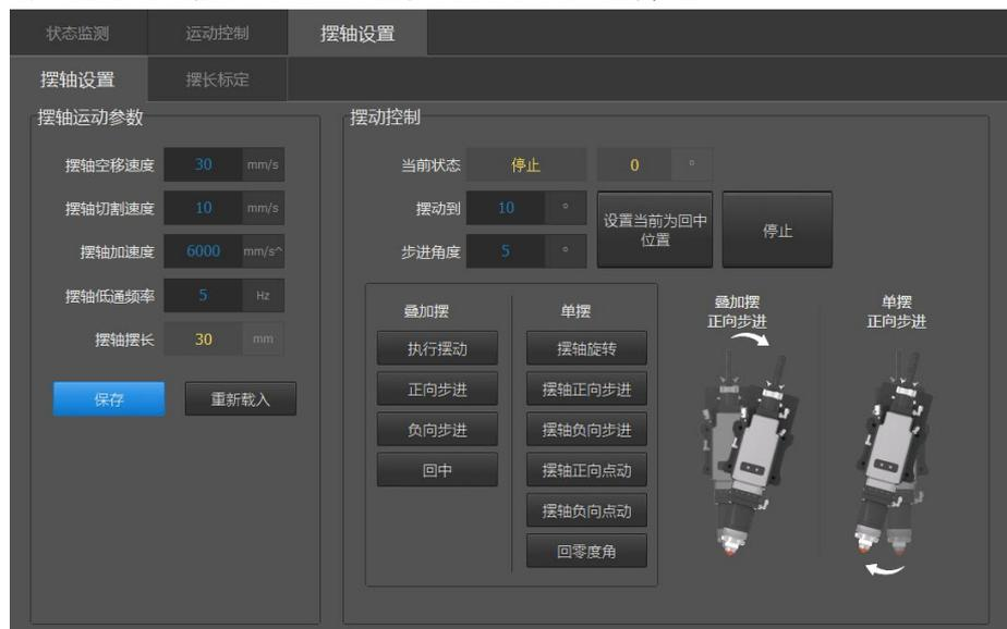
软件支持在 PLC 里开放坡口角度设置，范围为平台配置工具里设置的角度范围，不支持并行动作。在自定义过程里允许坡口切割设置角度。
