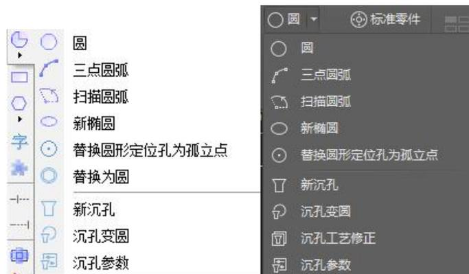
进入调试模块，在顶部菜单栏点击【圆】的下拉菜单，同样可生成沉头孔图纸。
