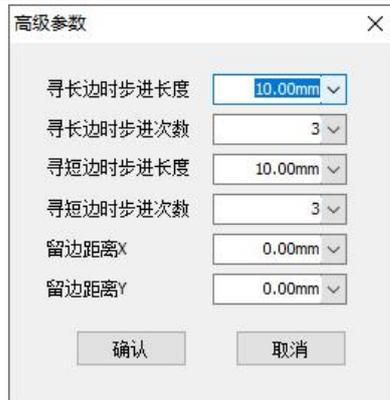
若识别点并非在与寻边起点沿 X 或 Y 方向平行的位置，则需要设置步进识别方式进行寻边，在高级参数中设置长边/短边步进次数及长度。
