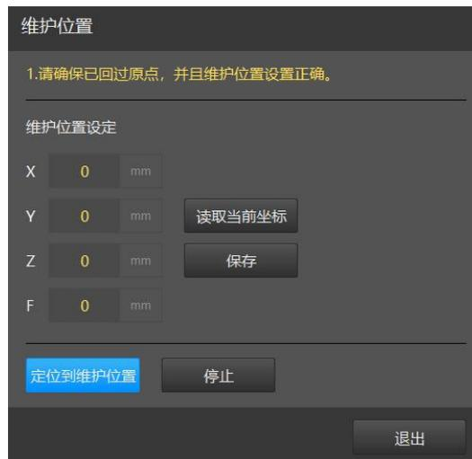
一般设置的维护位置在机床前方，方便操作工接触切割头，可用于激光对中、更换喷嘴等操作。该功能需要先在平台配置工具-高级配置界面启用【维护位置】后，才能在批量生产/灵活生产-辅助功能菜单下显示。
