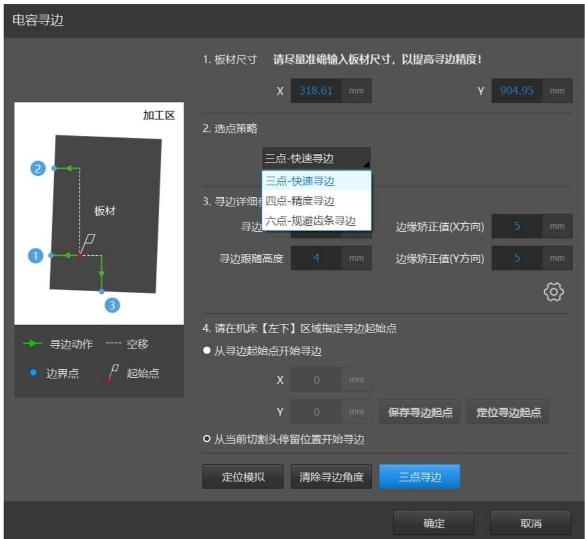
**板材尺寸:** 板材尺寸 X 为钢板在机床 X 轴方向上的长度; 板材尺寸 Y 为钢板在机床 Y 轴方向上的长度。
