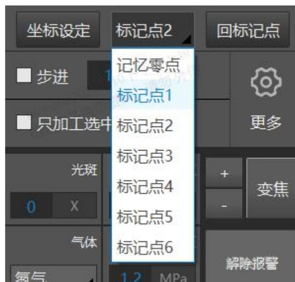
标记点能够自定义地标记机床幅面内某一个特定位置的坐标，方便用户将切割头快速运动
