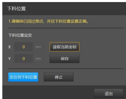
【下料位置】需配合交换台使用，在交换工作台前切割头会先回到配置的下料位置坐标处。该功能需要先在平台配置工具-高级配置界面启用【下料位置】后，才能在批量生产/灵活生产-辅助功能菜单下显示。
