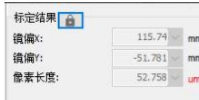
简单检验标定精度与定位精度：找到空白位置点射激光，再通过“相机→切割头”功能来目测检查相机中心位置与点射的圆点重合
