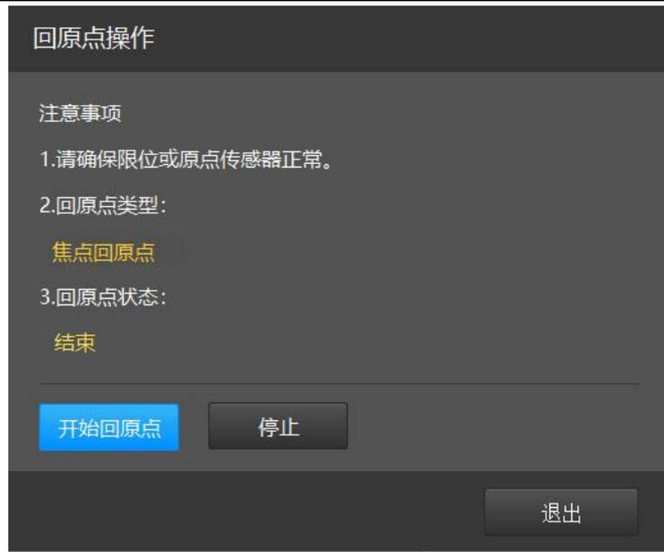
注意：当开启系统时存在其他报警，会导致开机无法回原点，需要解除其他报警后，再手动回原点解除原点报警。
