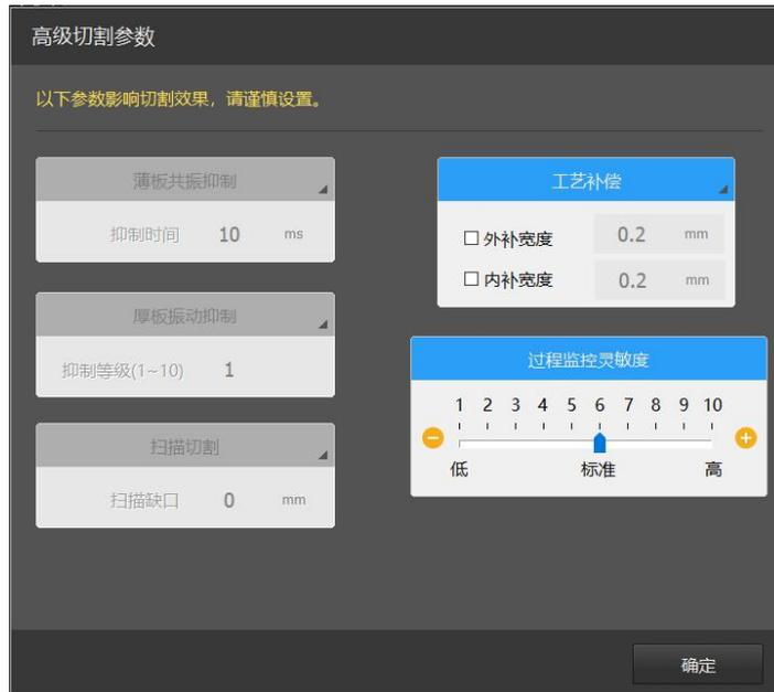
图 9-1 工艺修正—高级切割参数—工艺补偿
