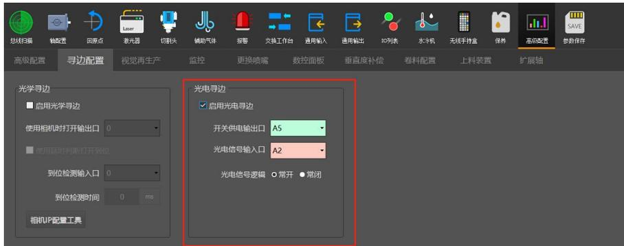
图 4-37 平台配置—启用光电寻边
