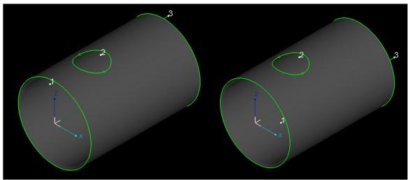
管面孔的引线位置分为远端、近端、长边引入和顶点引入,可以根据需要自行设置。 <引刀线>下拉菜单的<板外引入>是指为刀路加板外引入线,加工时从板外开光切割到板内,不用穿孔。<板外引入>和<板外引出>通常是用于槽钢、角钢、工字钢这类片体钢的。例如下图的异型管,经过<曲线分割>、<删除>等功能调整过刀路后,切断面的刀路是一段不封
