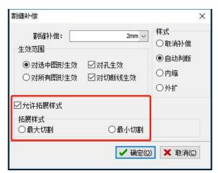
当管面上有斜切孔,要在这种斜切孔里插入与孔径相等的支管时,由于斜切孔的外壁轮廓线和内壁轮廓线并不一致,普通激光加工是按外壁轮廓线垂直于管面切割的,所以孔往往比支管小,支管在插入斜切孔时会产生干涉。
