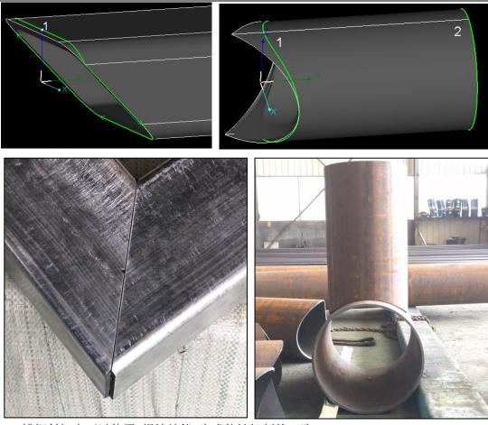
槽钢斜切也可以使用<焊缝补偿>生成能够切割的刀路。 下图分别是槽钢两种不同的斜切方式和使用<焊缝补偿>后生成的刀路。
