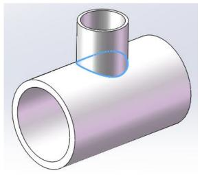
如果希望垂直切割弧面上的孔,就要给孔加上相贯孔工艺。加工相贯孔时旋转轴是不转的。
