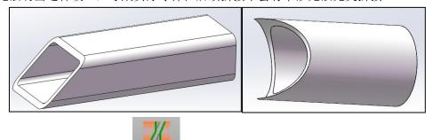
选中这种刀路或零件点"<sup>焊缝补偿</sup>",软件会根据截面信息自动算出合适的刀路,这样加工出来的零件可以正常拼接。
