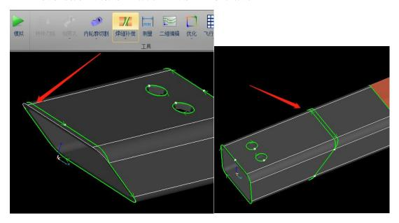
选中三刀切共边模拟可以看出来,三刀切刀路分为三段,如下图中的红色、黄色、蓝色三段。普通的三刀切刀序为红→蓝→黄(如左图),如果排样时同时勾选了<最后切断>,刀序为红→黄→蓝(如右图)。
