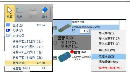
在零件侧边栏勾选中零件,点鼠标右键可以为选中零件批量添加补偿。
