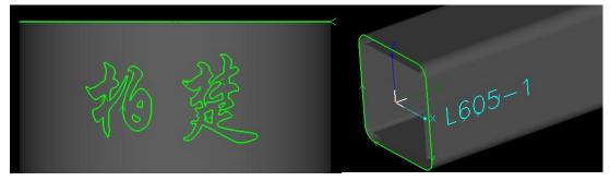
如果是希望便于零件分拣,可以在零件表面绘制零件编号,将文字放到另一个颜色的图层中,在加工软件 TubePro 里单独调节该图层的加工参数。
