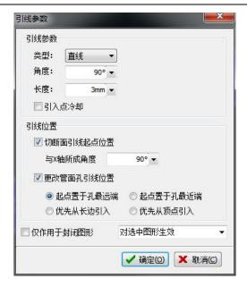
其中,引线类型可根据需要选用直线或直线+圆弧,引入点冷却是指在从引线到图形的 交点处自动插入一个冷却点。
