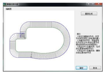
根据提示增加新的节点并拖动节点,更改凹角处的轮廓向量。
