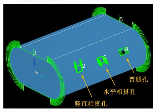
例如图中零件,切割图形2时,将保持当前角度、不转动旋转轴直接切割;切割图形3
