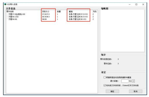
(5) 此时勾选<根据误差自动选择数据库中截面>,并设置一个合适的最大误差,例如 示例中的 2mm。设置完可以发现, 37.5 的方管和 38.5 的方管容差 2mm 的话可以合并入第 3 步添加的标准截面 38 的方管里, 所以截面数据都变成了"方形 L38 R3"的标准截面。
