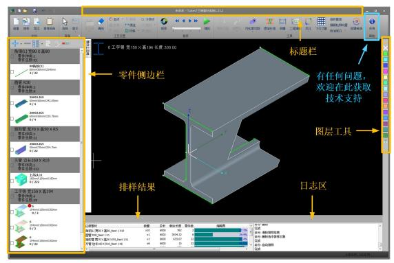
界面最上方是软件标题栏,可以看到软件版本。标题栏下方是工具栏。界面左侧是零件侧边栏,右侧是图层工具,下方分别是排样结果和日志区。
