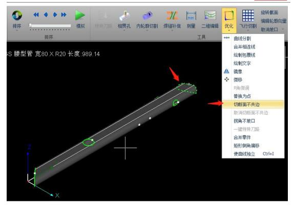
例如图中零件孤岛共边后,右端的孤岛较大,加工切到最后一个共边线时,共边线不够长,零件甩起来已经下坠了。
