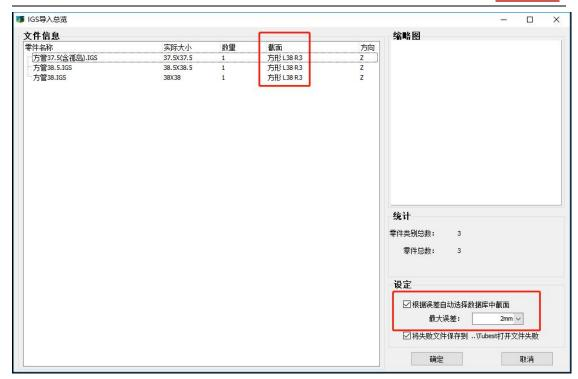
导入后,可以看到38.5 和37.5 的方管都被归到了38的方管里,可以一起排样加工。
