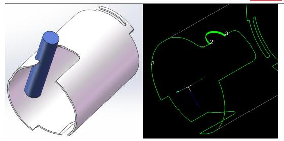
以相贯孔工艺加工这段圆弧时,切割的壁厚比普通的刀路厚,希望调节加工参数(例如将速度调慢)来获得更好的加工效果,所以将这段刀路放到另一个颜色的图层里(加工软件TubePro 里可以针对不同颜色的图层调用不同的加工参数)。
