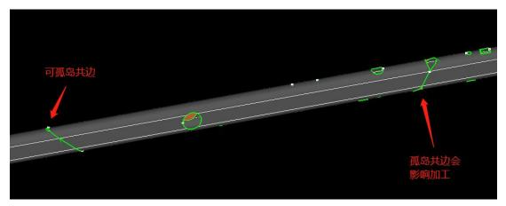
为解决此问题,可以将此零件右端切断面设为切断面不共边,排出如下结果:
