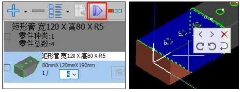
零件排入后,还可以进行手动调整(无论自动排样还是手动排样都可用)。点击零件即可召出快捷操作窗口,图示弹窗内的按钮分别为零件向前移动、零件向后移动、将零件从当前管材上移除、顺时针旋转、逆时针旋转、将当前零件沿 Z 轴转 180° (即上下表面不动、前后反转)。
