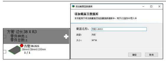
(4) 再次使用<从文件添加>, 批量导入其他截面精度有差异的 IGS 图纸, 例如示例中 的 37.5 的方管、38.5 的方管。打开时,在"IGS 导入总览"界面可以看到每个方管的实际大 小,也能看到导入后会被识别为什么截面。
