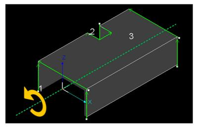
Shift+鼠标中键滚动:慢速旋转; Shift+鼠标中键拖动:中速旋转;
