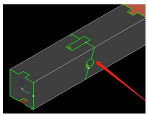
和三刀切共边一样,孤岛共边也有不同的刀路设计,分别为孤岛连割、孤岛三刀切、单零件切割三种,可以根据实际需要进行选择。
