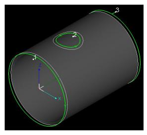
对于选中的图形,使用快捷键 "Ctrl+D"或者点选择菜单下的<快速补偿>,则不打开补偿参数界面,直接为选中的图形加上补偿。
