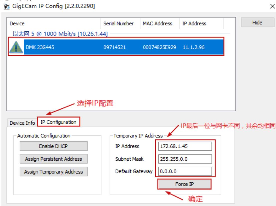
图 3.10 映美精相机 ip 配置（1）
