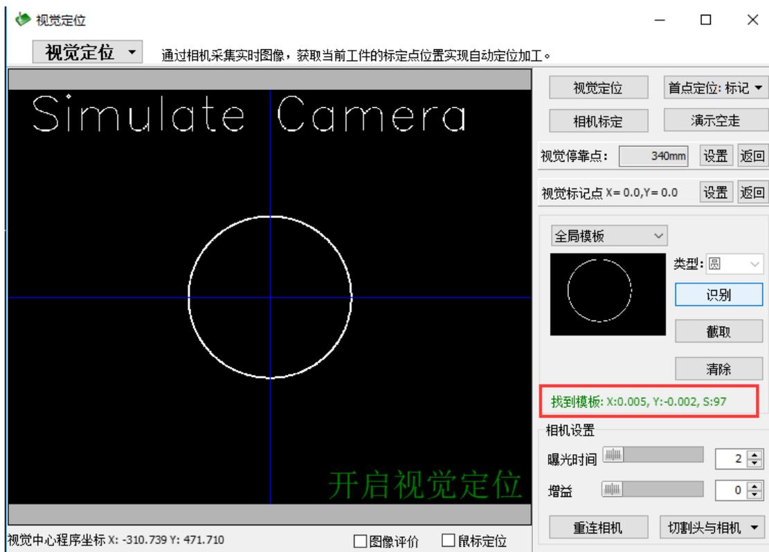
图 4.11 判别标定精度的示意图
