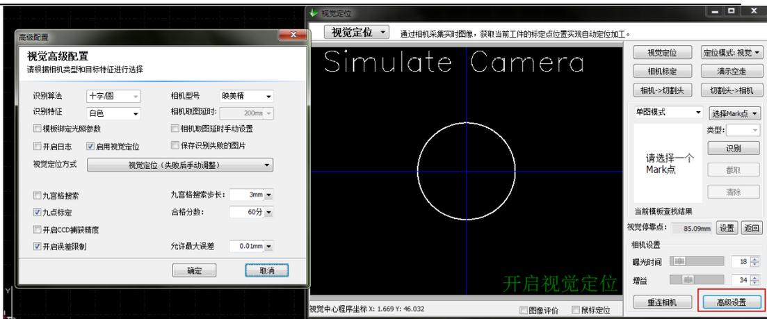
图 7.41 只有启用视觉定位以及打开视觉模块才会开启视觉定位
