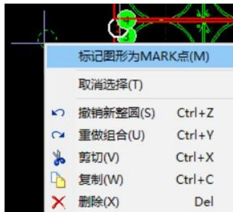
图 4.13 mark 点标记操作示意图
