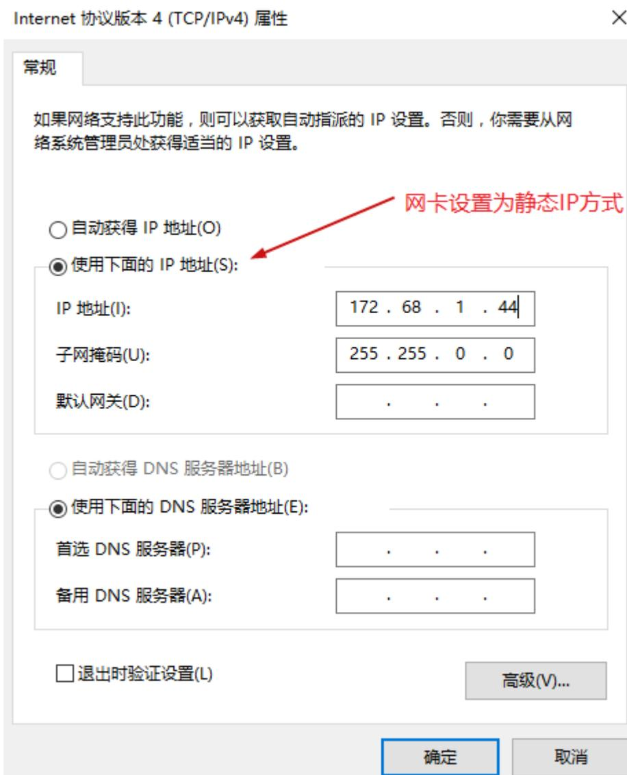
图 3.13 映美精相机 ip 配置（4）
