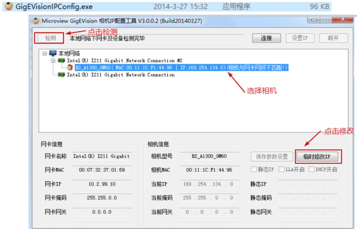
图 3.18 微视相机 ip 配置 (1)
